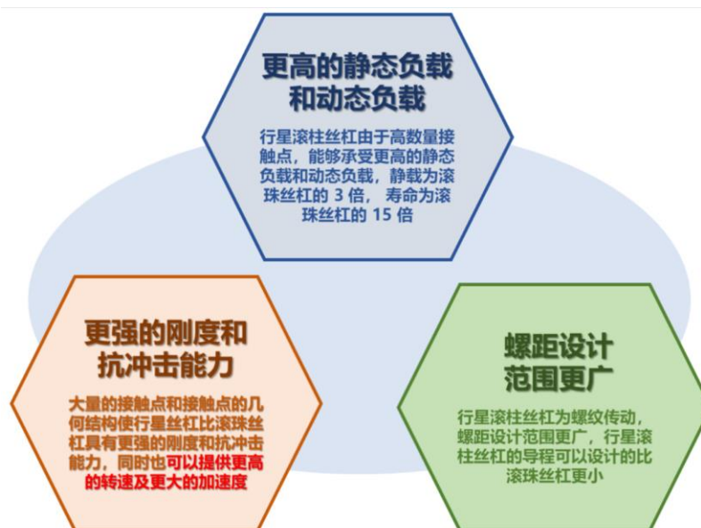
图：行星滚柱丝杠有望在机床设备、机器人/自动化、医疗器械/光学仪器等领域替代滚珠丝杠
