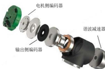
图5: 协作机器人关节模组中采用双编码器
