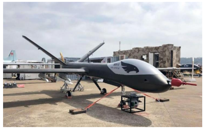
图4：翼龙-1D 是国内第一架全复材多用途大型无人机
