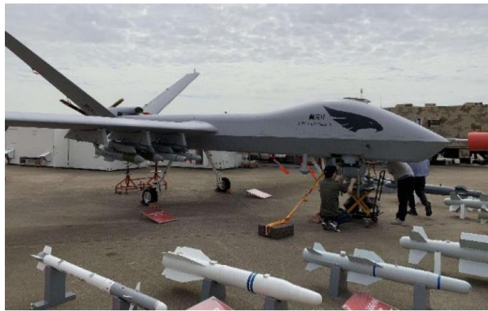
图5：翼龙-2 是我国第一型国产涡桨动力大型无人机
