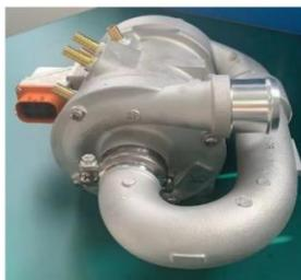
氢燃料电池汽车空压机压力回收和整流器
