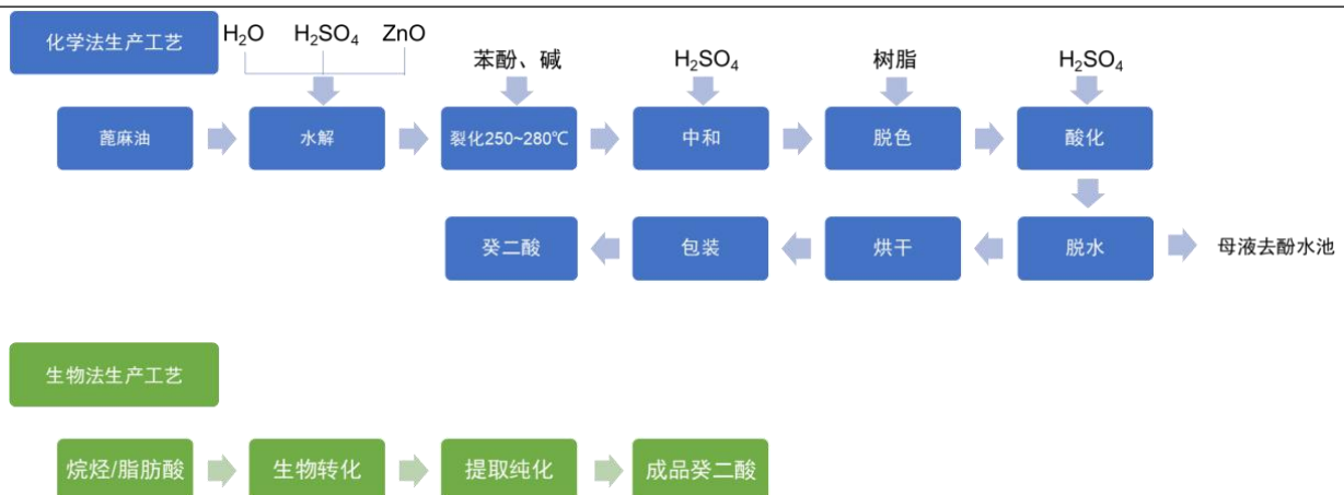
图 30：生物法癸二酸相比化学法的工艺更加简单，且制备环境温和环保
