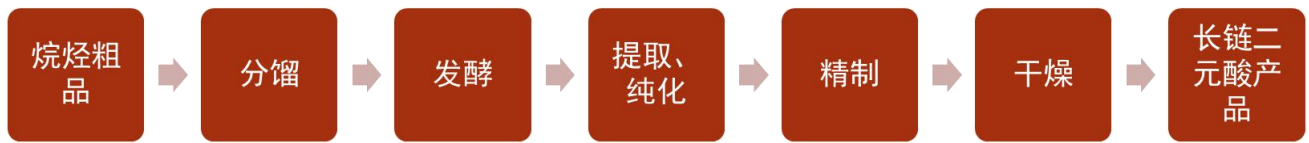
图 18：生物发酵法长链二元酸的生产工艺
