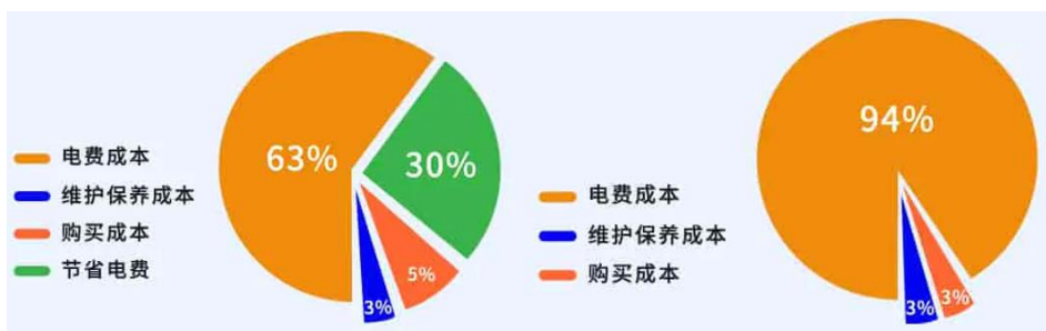
图 18：高端节能型空压机（左）与普通空压机（右）使用成本对比
