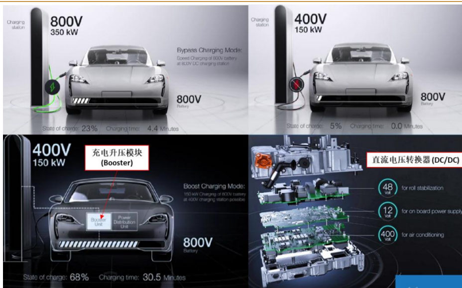
图 26: 公司 800V 多合一电压转换器工作示意图
