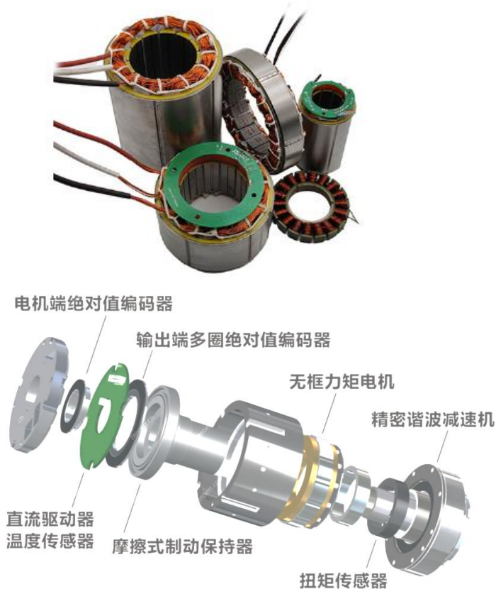
图 无框电机通常与其他零部件组合成机器人关节模组
