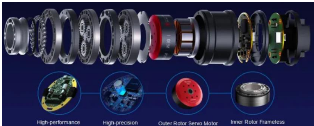
图 半直驱关节模组结构拆分图
