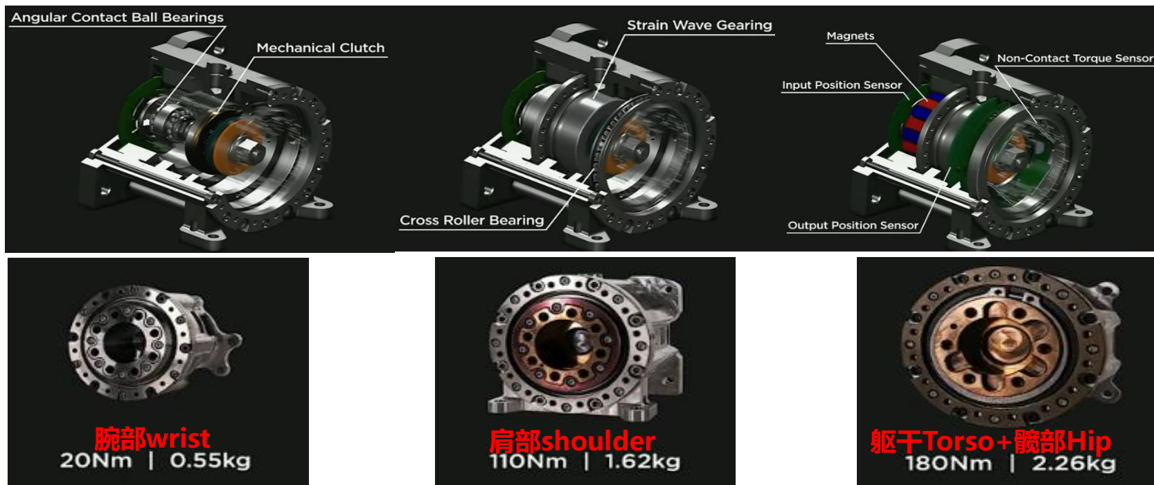
图 特斯拉Optimus旋转执行器结构及种类
