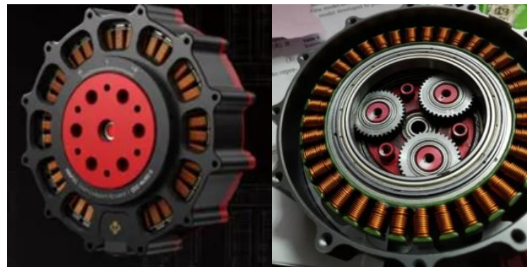
图 半直驱关节的电机+行星减速器部分
