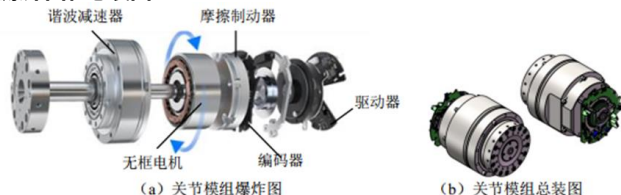
图表：关节模组爆炸图和总装图
