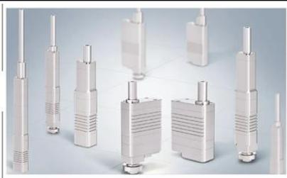
微型伺服电缸是一种小型一体化直线伺服系统，是机器人、医疗器械、工业设备等精密机电设备的核心运动部件。其内部集成了空心杯电机、精密行星减速器、传感器、精密螺杆机构及闭环控制系统，具有体积小、精度高、负载大等技术特点，可以实现行程范围内任意位置精确伺服控制。内置绝对位置传感器，断电后不会丢失位置信息，无需找零位。
