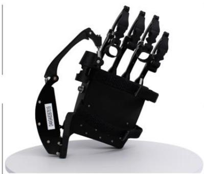
外骨骼机械手是一款穿戴式机械手产品，集成微型伺服电缸、角度传感器和力传感器，可以实时采集和控制每一个手指的抓握力，具有仿生设计、力感知、力控制和快速响应等特点。
