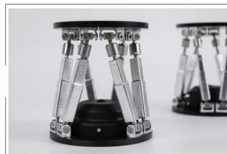
6自由度Stewart平台是一个并联机器人，由6个独立微型伺服电缸支撑的表面组成。该平台可在三维空间内任意调整位置和朝向。应用领域包括飞行器仿真、精密光学实验和机床工具等。
