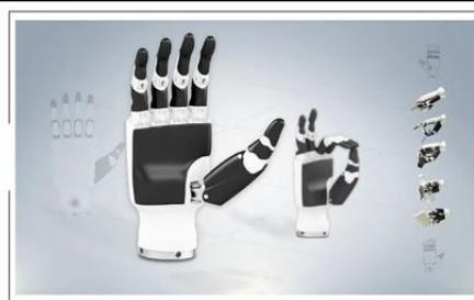
因时机器人的仿人五指灵巧手采用创新型直线驱动设计，内部集成了6个微型伺服电缸。单手具有6个自由度和12个运动关节，外形美观且高度仿真，结合力位混合控制算法，具有亚毫米级定位精度和数千克的负载能力，可以模拟人手实现精准的抓取操作。应用于服务机器人末端执行器、假肢、教育科研装备和特种工业应用等。
