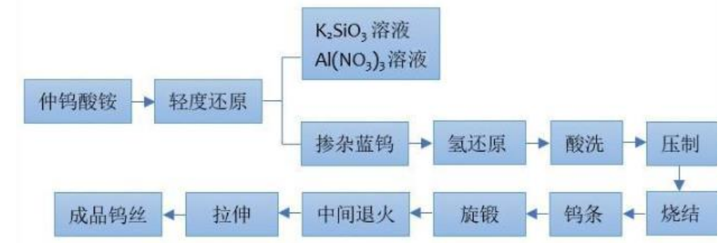
图表 56：钨丝生产工艺流程
