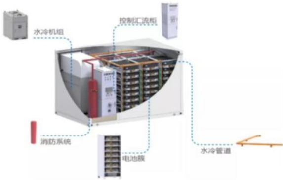
图 37: 储能电站液冷工作示意图
