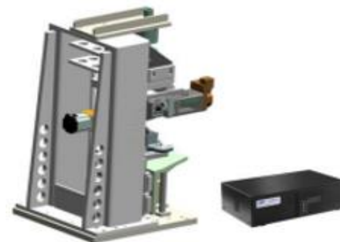
图30：复合集流体用超声波滚焊机
