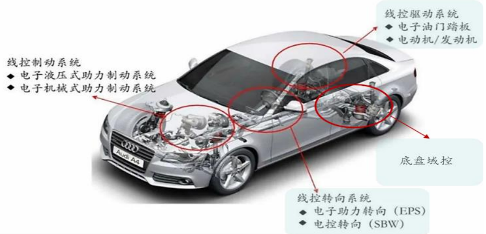
图12：线控底盘由多个子系统构成
