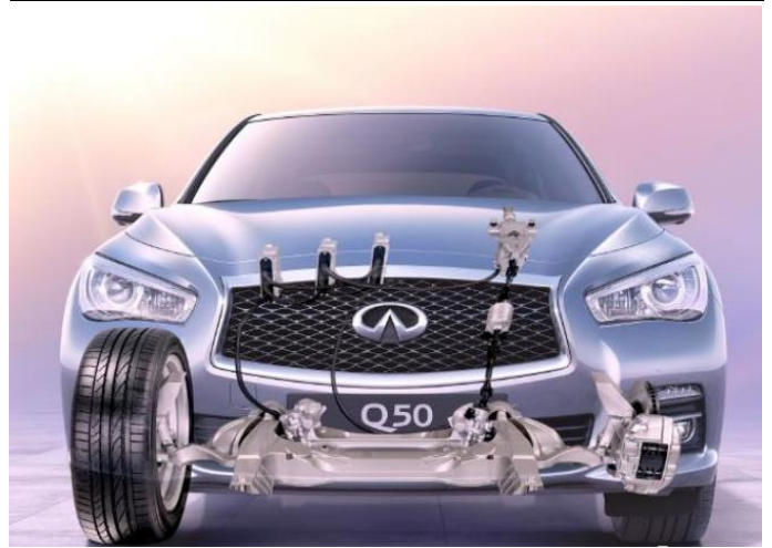
图18: 英菲尼迪 Q50 是首个搭载线控转向的量产车
