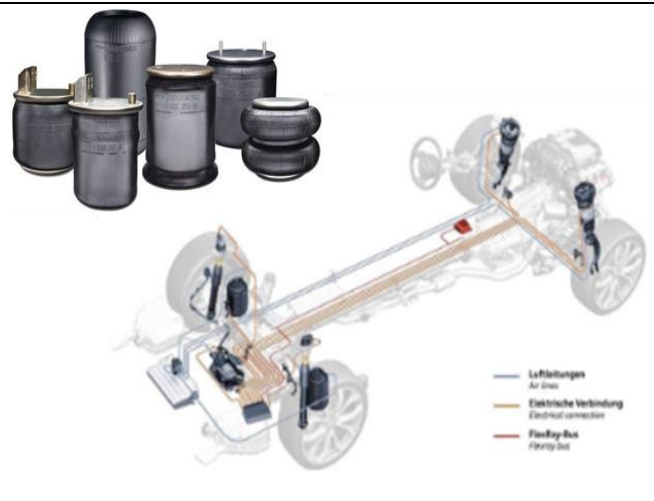
图22：空气弹簧是良好的线控弹簧形式之一
