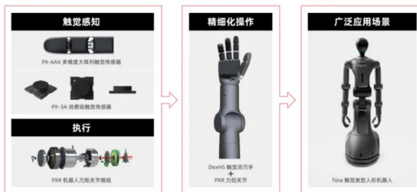
图14: 帕西尼通过多维度大阵列触觉传感器实现精细化操作
