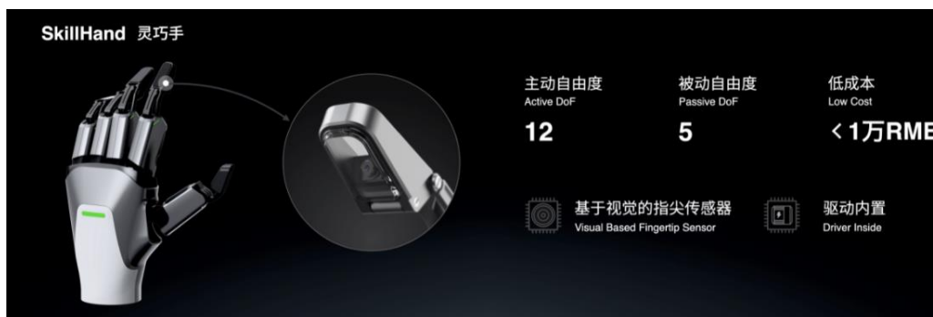
图12: 智元机器人灵巧手集成了基于视觉的指尖传感器
