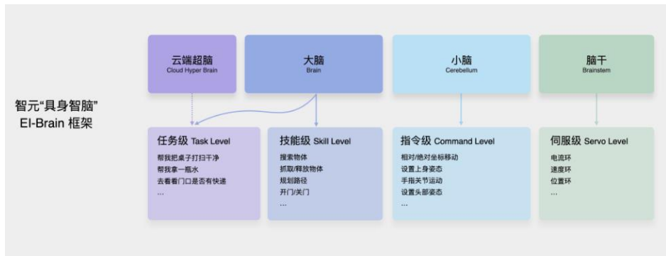
图17: 智元机器人具身智脑将机器人把控制系统分为超脑、大脑、小脑、脑干几层
