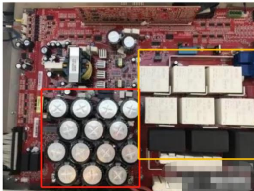
图32：古德瓦特 MAX 80KW 逆变器母线电容采用铝电解电容（红）和薄膜电容（黄）组合设计
