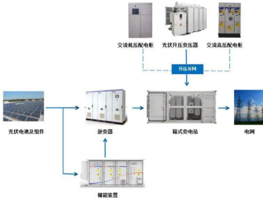
图 13：升压并网变压器为光伏电站必备设备
