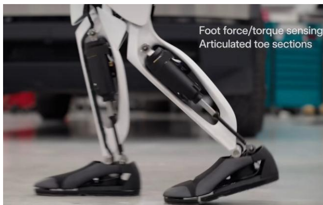
Optimus手腕和脚腕关节使用六维力传感器
