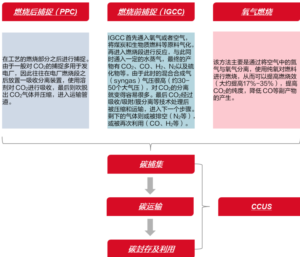
图23 CCUS 技术及碳捕集三种方式
