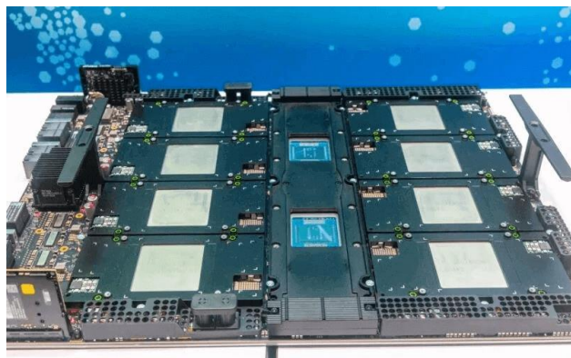
图 3：HGX B200 无散热片主板
