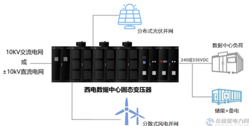
图 25：西电贵安数据中心固态变压器
