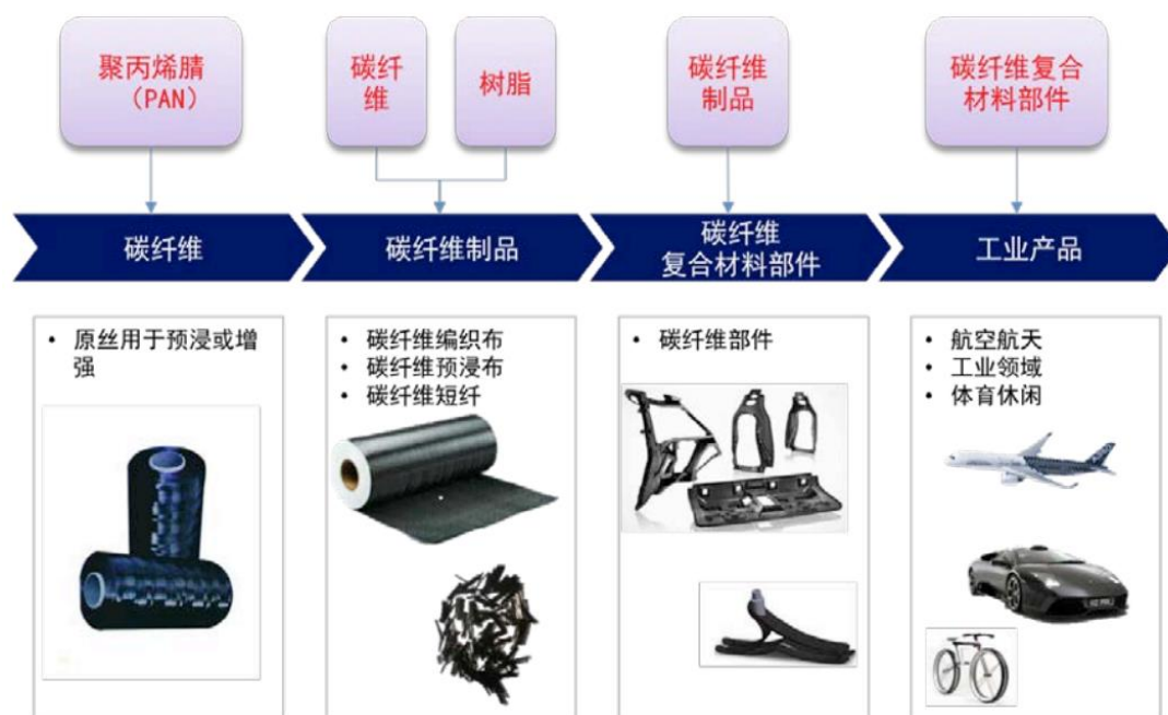
图 23：碳纤维产业链示意图
