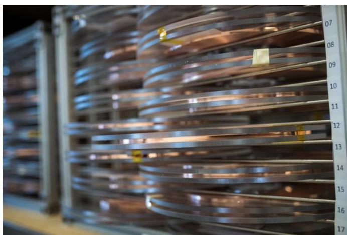
图表35：SPARC 项目内部使用的高温超导带卷轴
