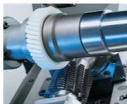
**原理：**运用展成法原理，用滚刀加工齿轮，相当于一对交错螺旋轮啮合
