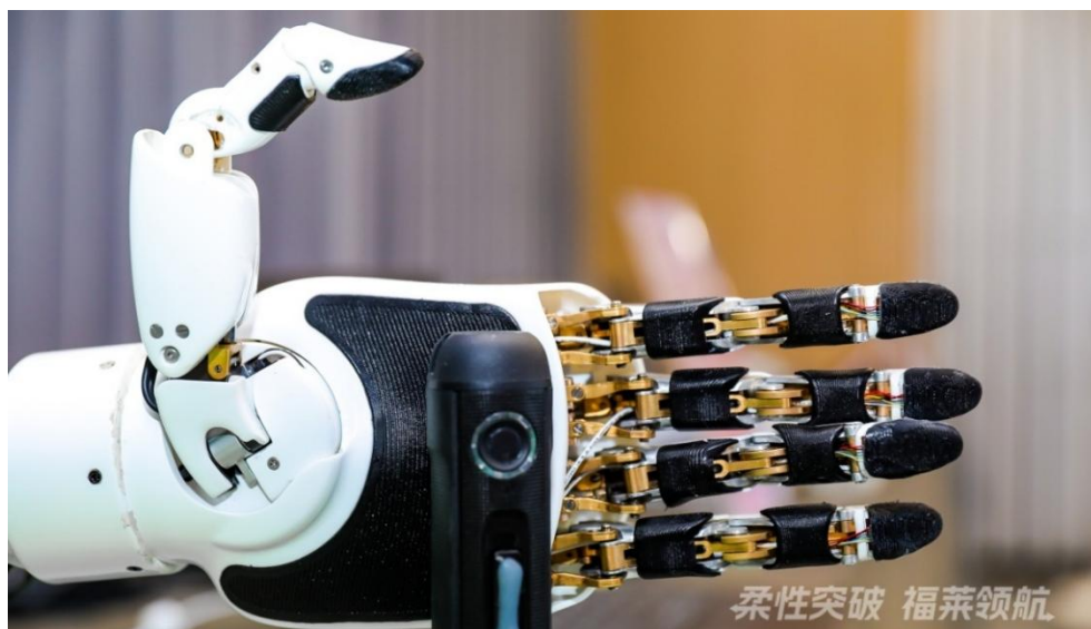
图 4：搭载福莱新材柔性传感器的灵巧手
