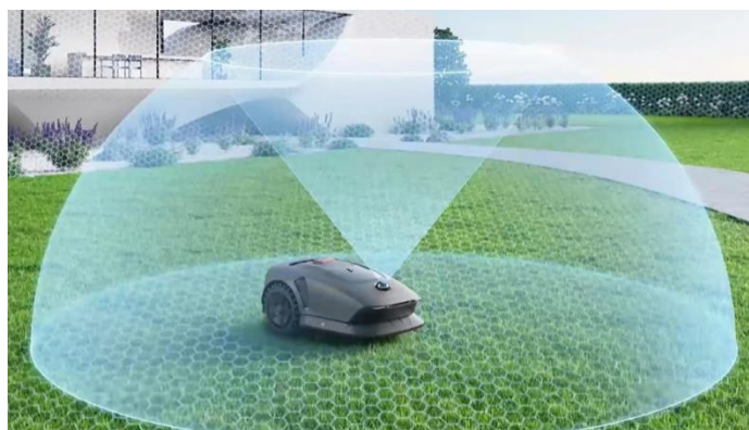
图表27：追觅 MOVA 搭载禾赛 JT16 实现 360^{\circ} 感知
