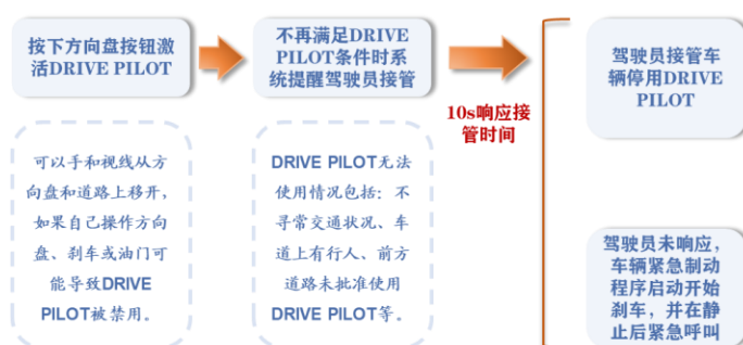
图表8: 梅赛德斯 L3 级 DRIVE PILOT 系统设置 10 秒响应接管时间
