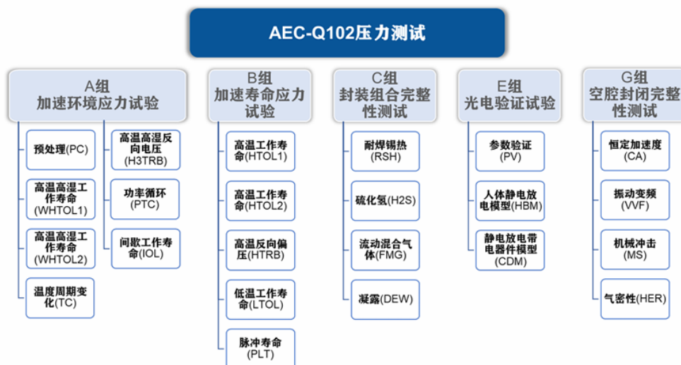
图表40：车规要求高可靠低容错，AEC-Q102 压力测试项目包含数十项测试
