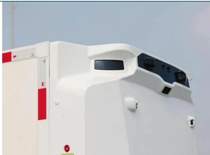
图表33：九识智能无人车搭载 4 颗禾赛 AT128 激光雷达
