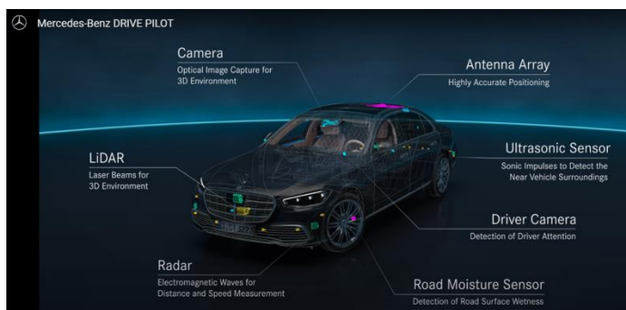
图表7: 梅赛德斯 L3 级 DRIVE PILOT 系统配备一颗激光雷达
