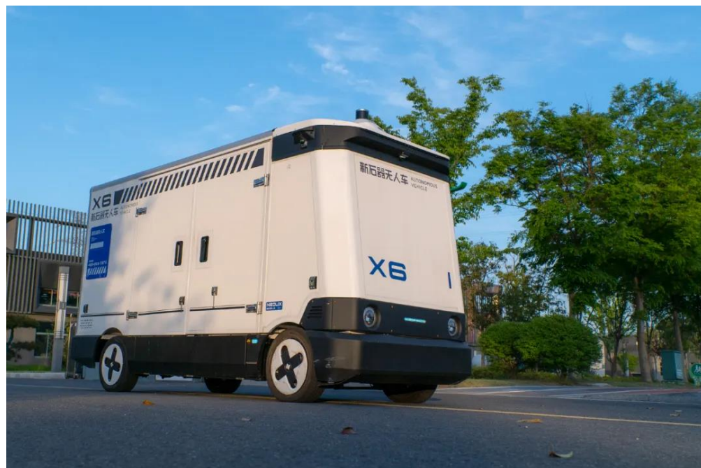
图表1：无人物流车产品形态（以新石器无人车 X6 为例，装载容积 6m³）
