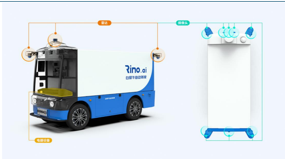
图表9：白犀牛无人车载有雷达、摄像头等零部件
