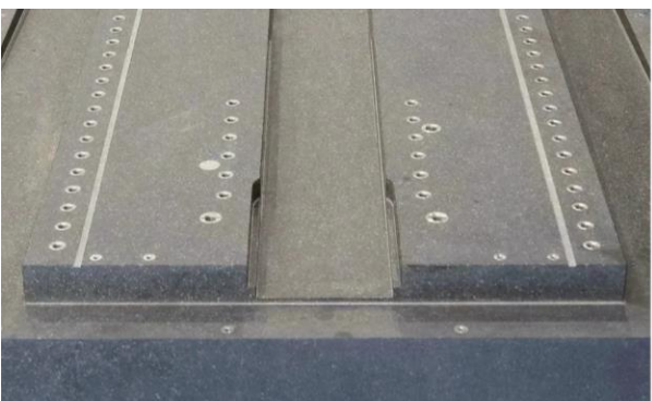
图：汉布雷格超精密硬车床花岗岩底座
