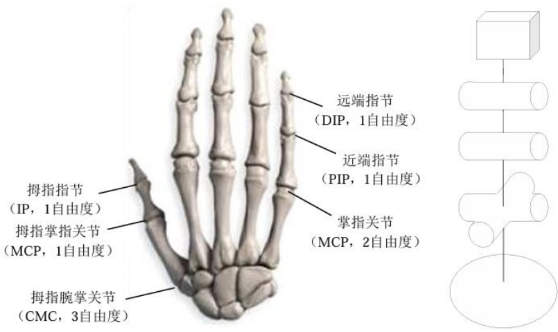
图：人手骨骼模型及运动学简图
