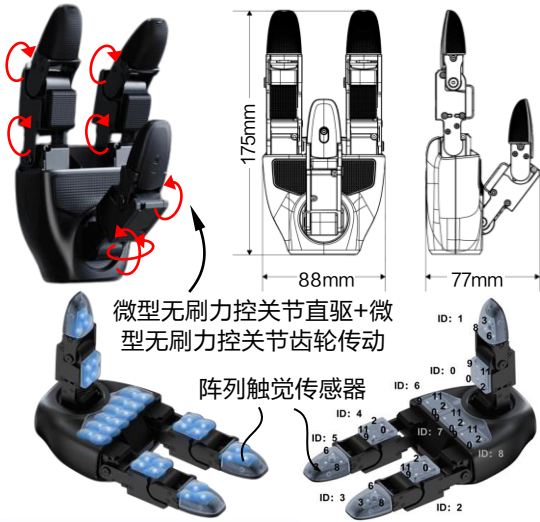
图：宇树Dex 3-1灵巧手结构示意图
