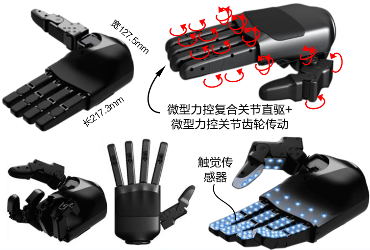
图：宇树Dex 5-1灵巧手结构示意图
