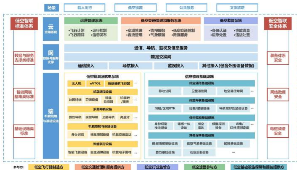
图23：低空智能网联体系参考架构
