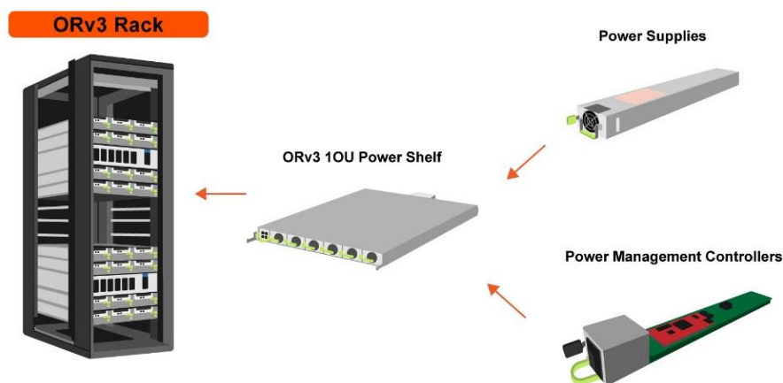
图表12：一组电源架 (Power Shelf) 由 6 个 PSU 组成
