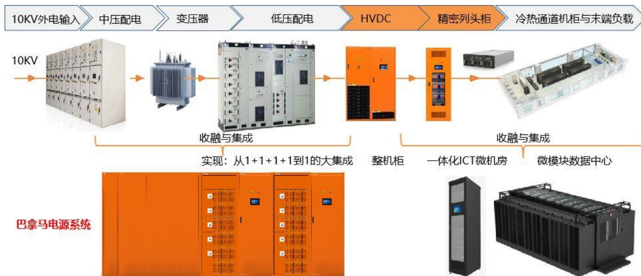
图表23：中恒电气 HVDC-巴拿马电源系统通过模块化、集成化设计可节省占地面积 50%
