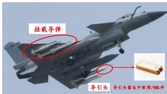
图表78：国博电子T/R组件应用于导弹导引头雷达
