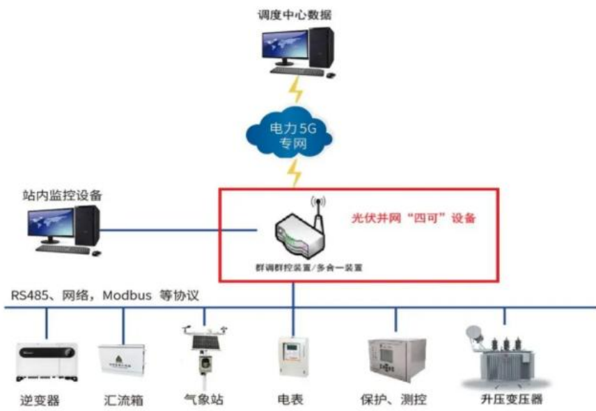
图：基于群调群控装置的工商业分布式光伏接入方案
