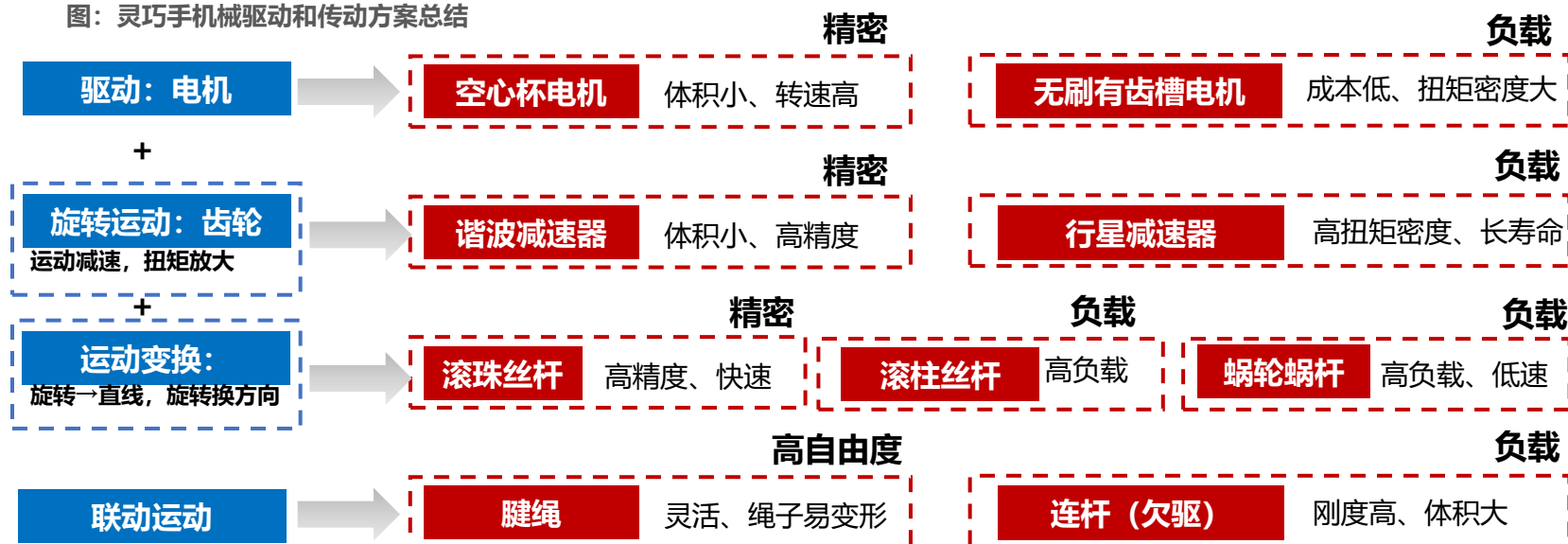
图：灵巧手机械驱动和传动方案总结
