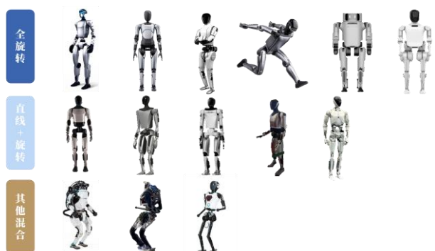
图28：人形机器人主流旋转关节模组，但也有其他解决方案
