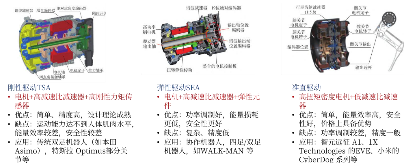
图55: 人形机器人旋转关节驱动方案
