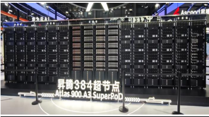
图35：华为昇腾 384 超节点采用液冷方案
