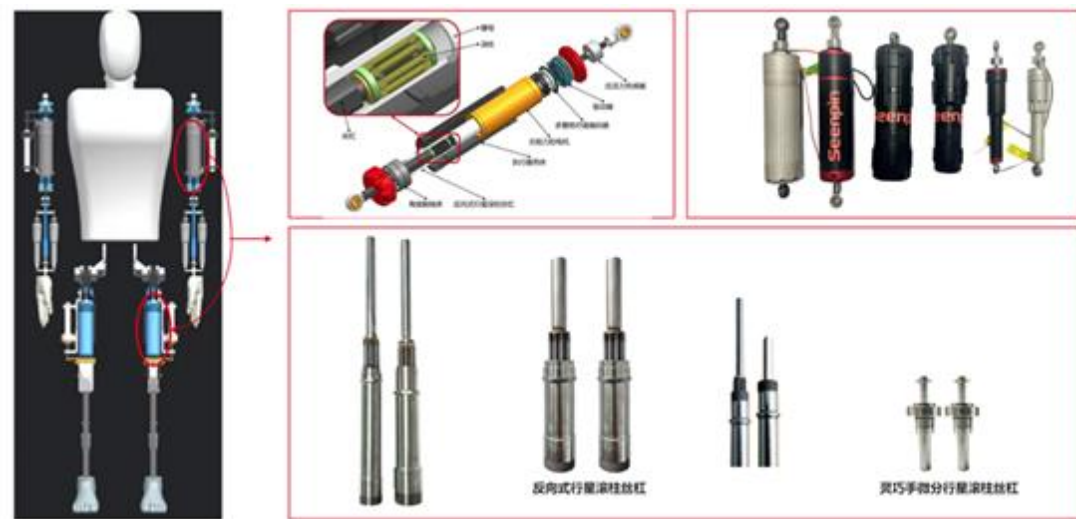
行星滚柱丝杠在人形机器人中应用示意图
