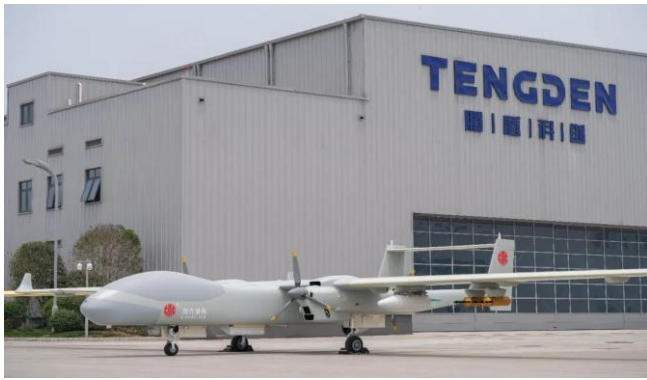
图 73：中信海直“双尾蝎 A”人影专用型大型三发固定翼无人机系统
