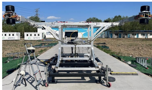
图 66: 小功率典型规格完成所有台架及铁鸟测试
