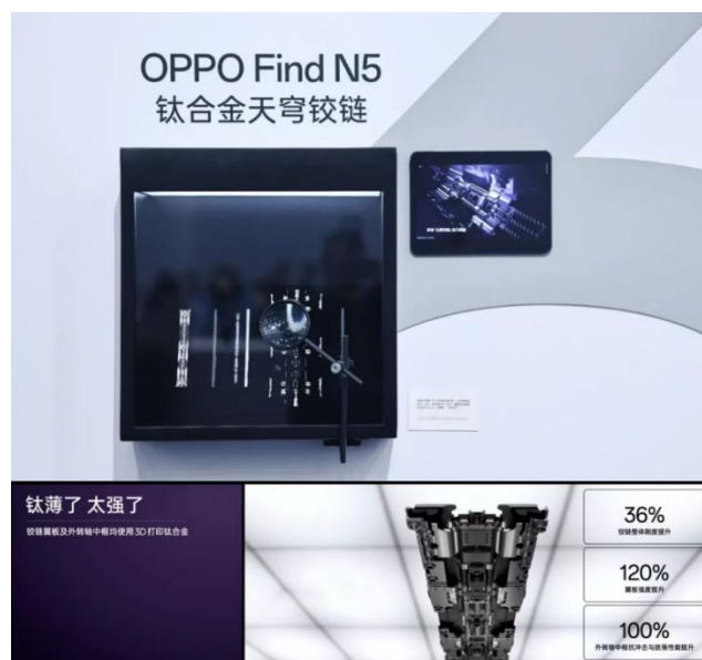
图表56：OPPO Find N5 采用 3D 打印打造铰链、翼板及外传轴中框
