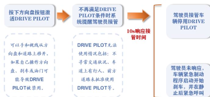
图表69：梅赛德斯 L3 级 DRIVE PILOT 系统设置 10 秒响应接管时间
