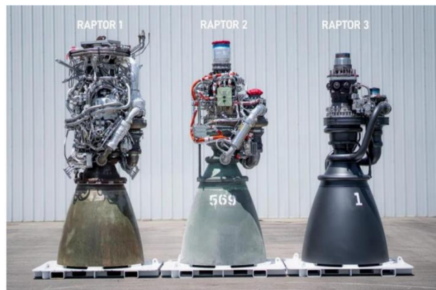
图表52：第三代猛禽发动机通过 3D 打印工艺，将前两代的多零部件整合为一
