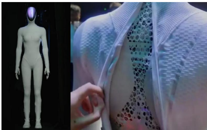
图表53：3D 打印制造轻量化弹性体为 IRON 机器人塑造“肌肉”
