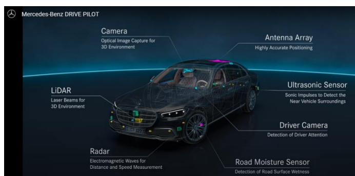
图表68：梅赛德斯 L3 级 DRIVE PILOT 系统配备一颗激光雷达
