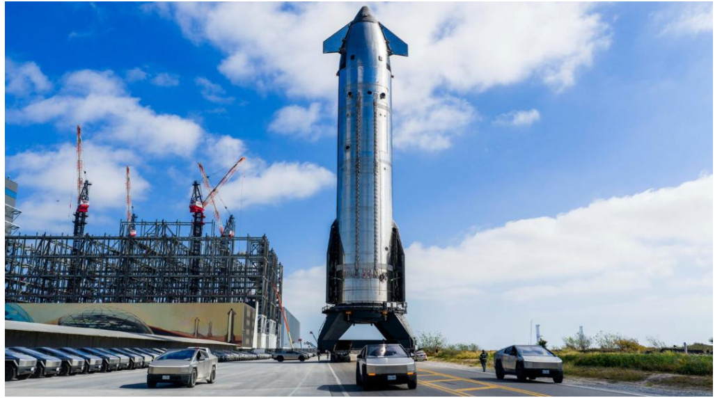
图表10: S39 计划从生产基地前往马西前哨站进行发射前低温耐压测试
