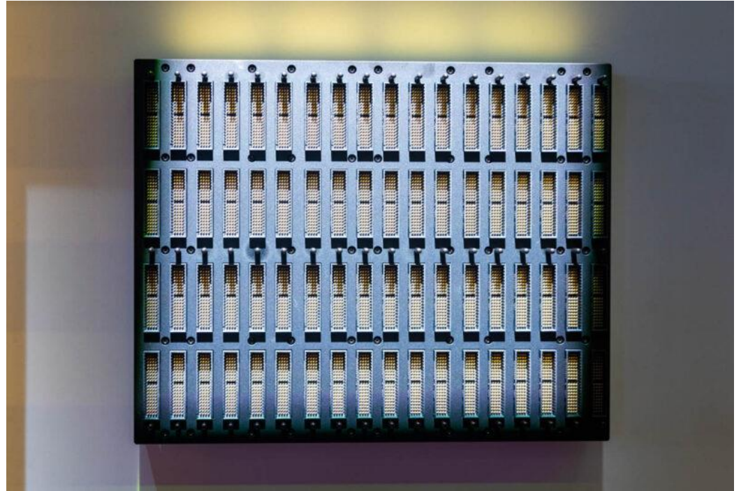
图表6: 通过内部连接, NVIDIA 展示了一种新的中翼设计, 其共有 18 列和 4 排连接线
