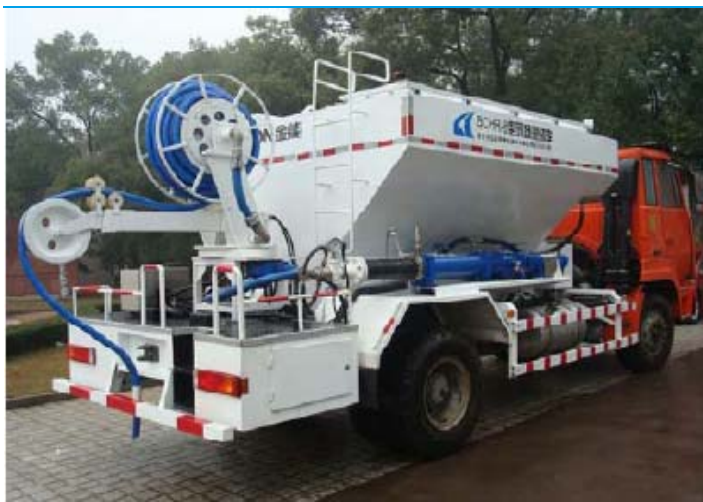
图表8：炸药现场混装车
