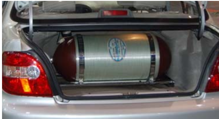
图 5: 车用玻纤缠绕 CNG 气瓶图示
