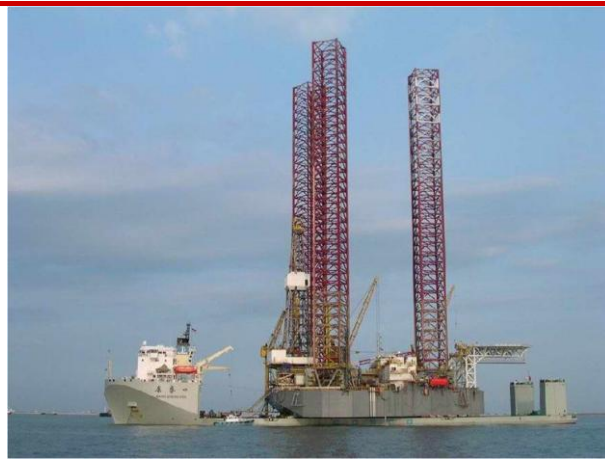
图 11 康盛口运载 ENSCO 88 钻井平台 (2004.11)
