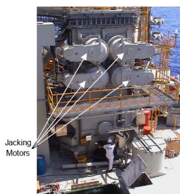
图 5 升降系统的电动机
