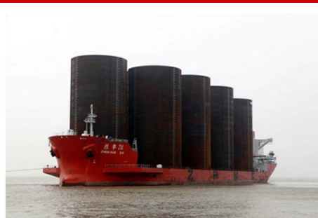
振华 24 船运输港珠澳大桥巨型管桩
