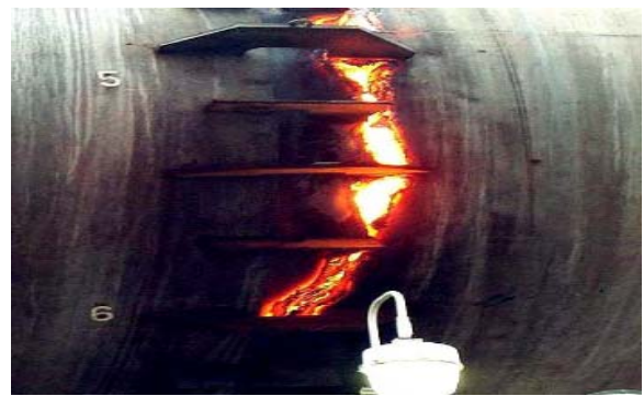
图 2： 耐火材料未及时更换导致的窑炉过热
