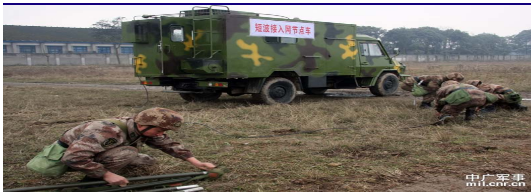
图 19: 短波接入网节点示意图
