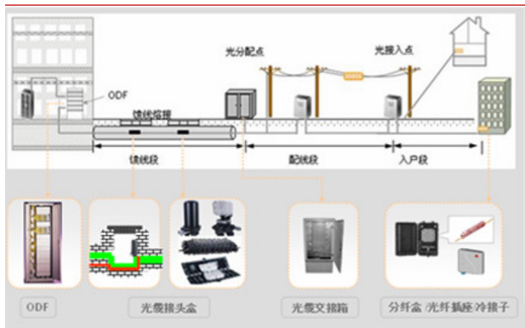
图表 1 ODN 基本结构
