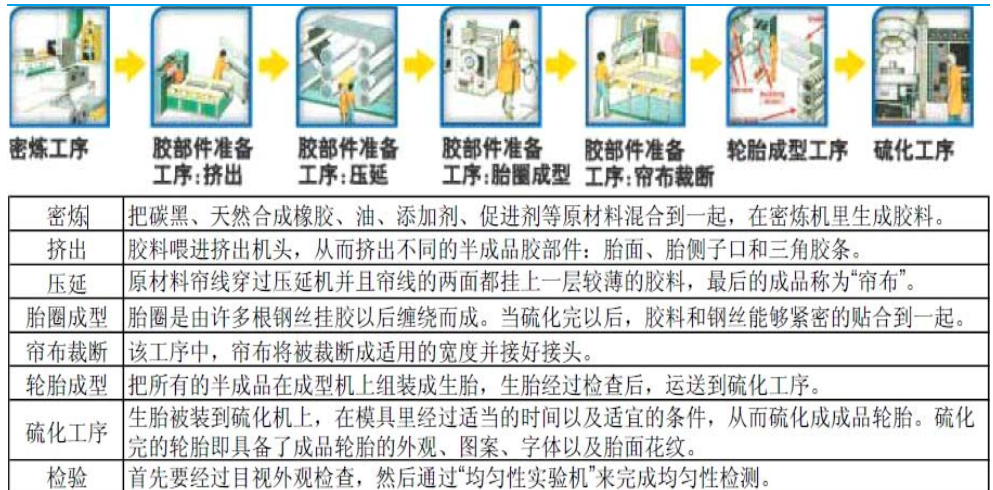
图表7: 轮胎成型机用于轮胎组装成生胎
