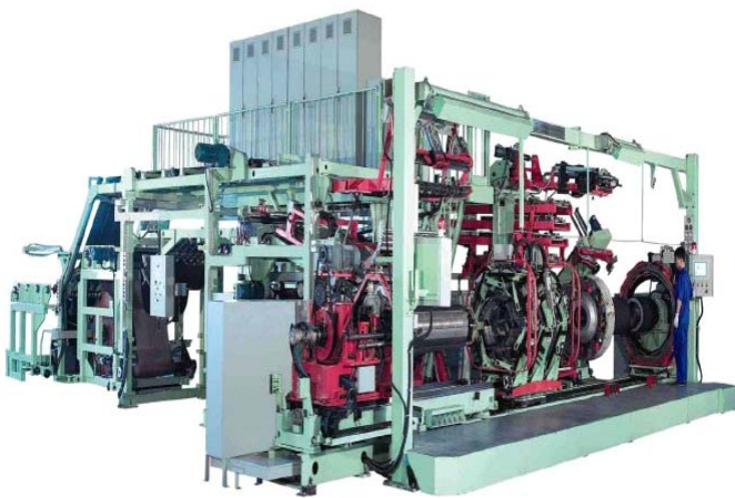
图表2：公司生产的全自动子午线轮胎成型机
