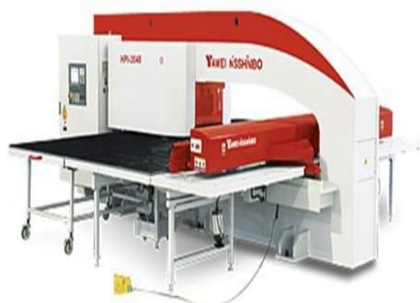
图 24 公司生产的数控转塔冲床
