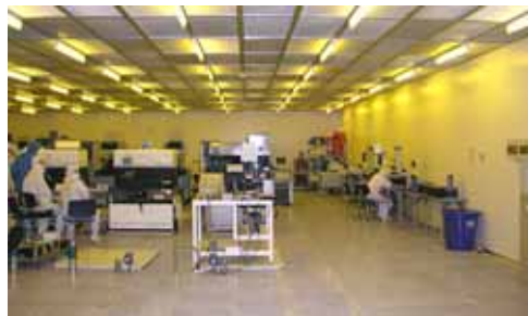
0.1 μ 10 级微电子洁净室
