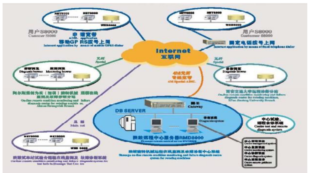
图 10 陕鼓旋转机械远程在线监测及故障诊断中心示意图
