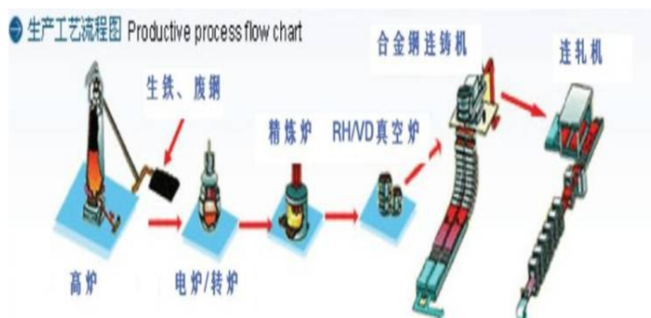
图 4：新冶钢生产流程
